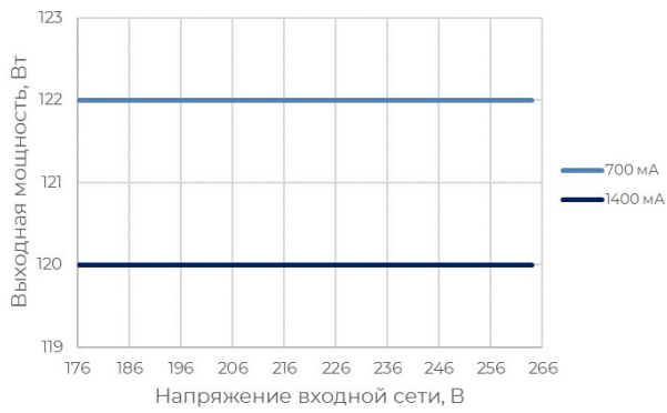
Рис. 1 - Зависимость выходной мощности от напряжения входной сети
